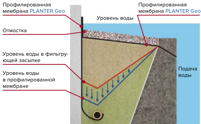
Рис. 3. Модифицированное решение пристенного дренажа с профилированной мембраной PLANTER Geo.
