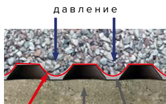
Иглопробивной геотекстиль Несжимаемая основа дренажа Дренажный канал
