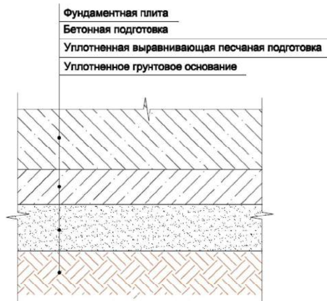
Рисунок 1 – Конструкция фундамента с подготовкой из бетона
